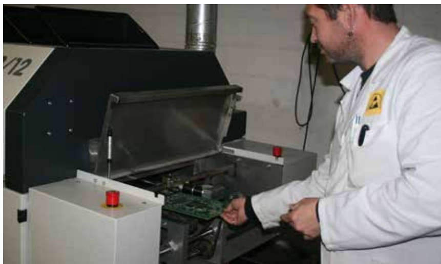
Un four à refusion 'fond' pour ainsi dire les composants sur la plaque.
