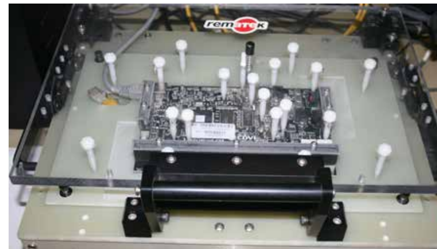
Avant de quitter l'usine de Bury, toutes les fonctions de chaque produit fini sont vérifiées une par une sur des bancs d'essai. (Photo : Atrium A22)
