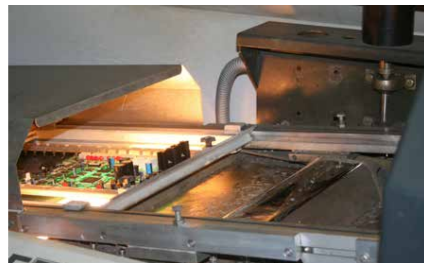
Après assemblage manuel, les composants de puissance lourds sont soudés dans un bain d'étain.
