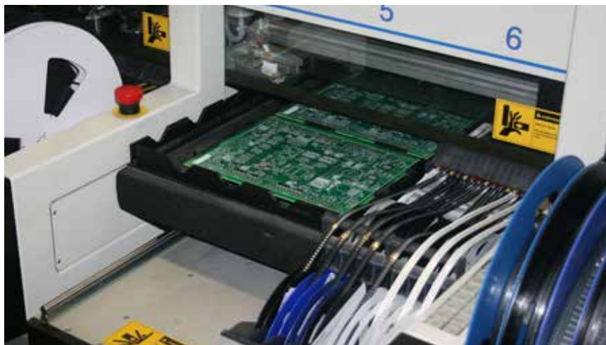
L'assembleuse, où les composants sont fixés sur les circuits imprimés. (Photo : Centaur CT-V900 )
