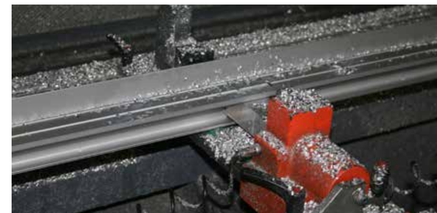
Dans un autre secteur de l'usine de Bury, les systèmes de verrouillage de CDVI sont fabriqués et assemblés à partir de profils en aluminium.
