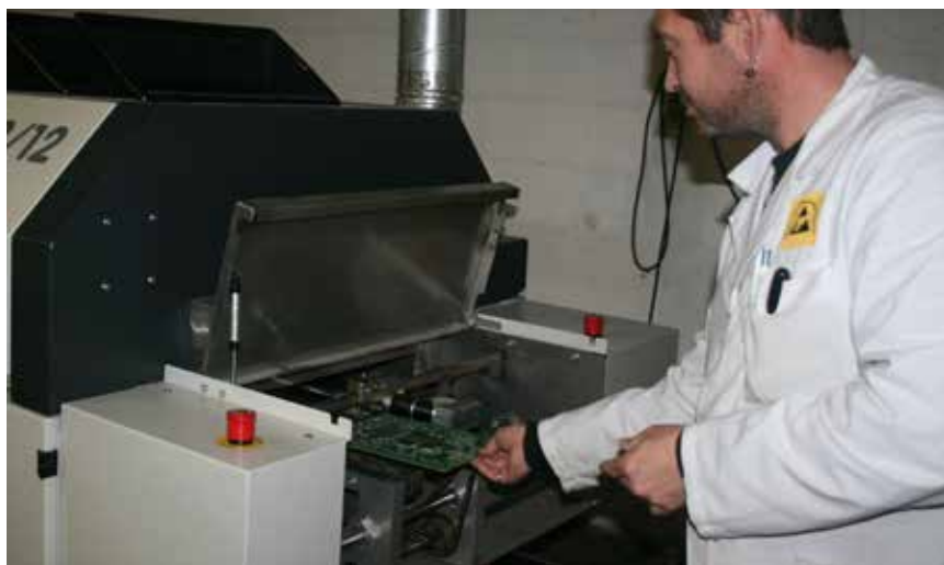
In een reflow-oven worden de met componenten bestukte printplaten als het ware versmolten.
