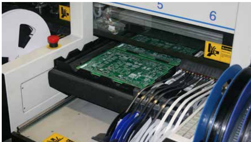
In de bestukingsmachine worden de componenten op de printplaten aangebracht. (foto: Centaur CT-V900)
