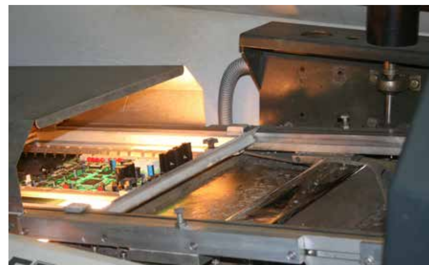
Na de manuele bestukking met de zware vermogenscomponenten worden die in het tinbad vastgesoldeerd.
